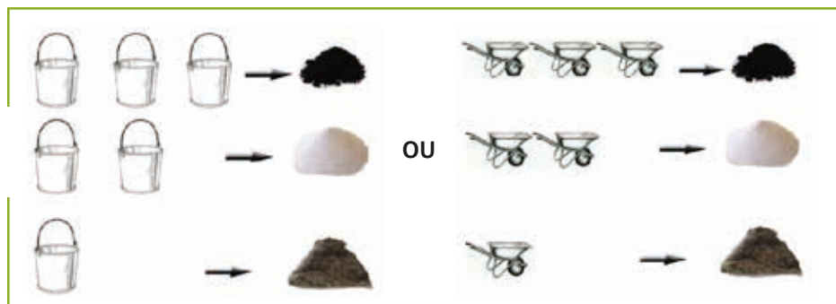
Plaque 3 : Mesure de la proportion du substrat à l'aide d'un pot ou d'une brouette
